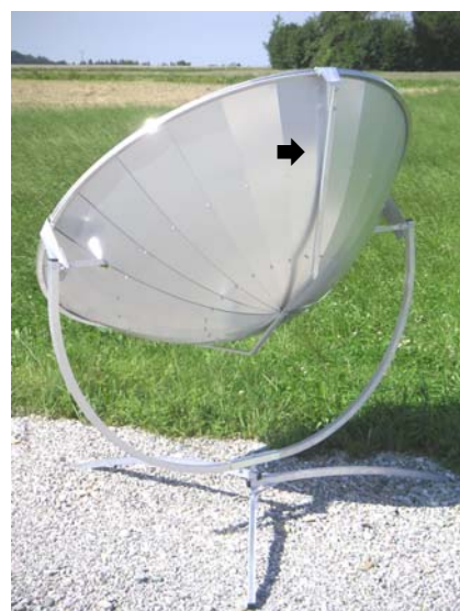
Rückansicht - Der Reflektor ist durch einen Überrollbügel (Pfeil) vor Beschädigungen geschützt.
