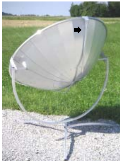
Vue de dos du cuiseur solaire. Le réflecteur est protégé de tous dommages par un arceau de sécurité voir flèche.
